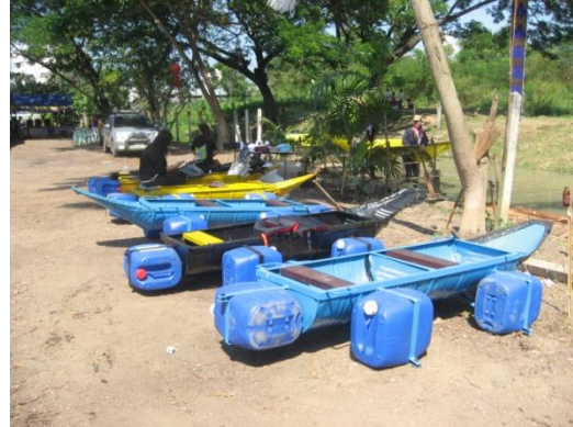
図6 バンコック洪水時にCMUが提供の簡易ボート (石油ポリタンクを浮きに利用)
