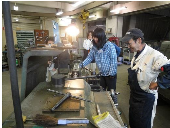
工作機械の実習(旋盤：削られた鉄くずは400°)
