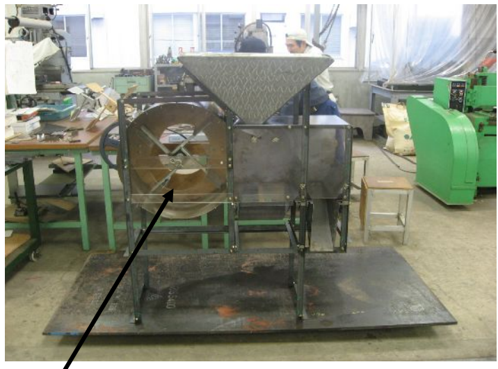
風洞、ファンの部分を透明にし粉の流れを見やすくした
