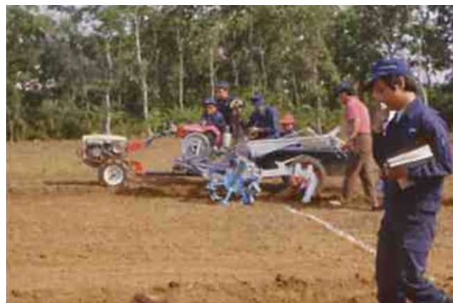
写真1. 圃場で鉄車輪と和犁の耕起特性テスト
