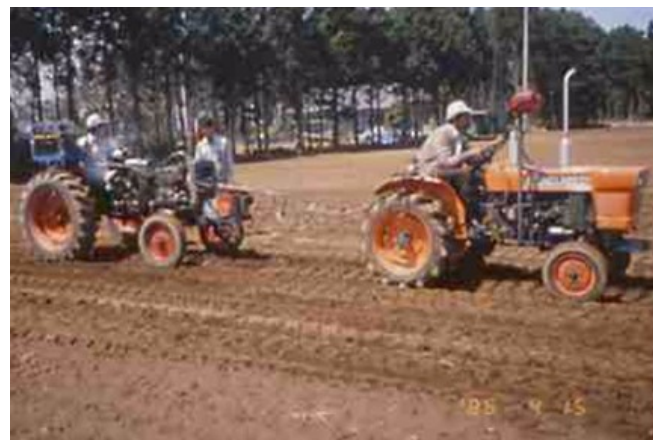
写真2. 圃場でトラクターのけん引性能実験
