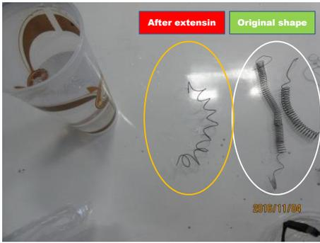
Fig. 3 バネ形状記憶合金の変形（左）と元の形状（熱い湯につけるとバネの形状に戻る（右）
