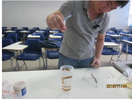
Fig. 4 変形した形状記憶合金がバネ状の元の形に戻る状況を観察する学生
