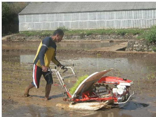
Fig.10 日本製2条用田植え機
