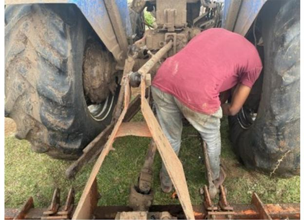
代掻き中に破損したロアリンクを修理するオペレーター、間に合わせの工具と道具で対応 \_\_タンザニア
