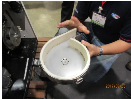
図6 インペラ式もみすり機の内部構造
