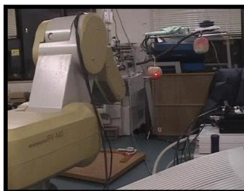
図 2 レーザーポインタで対象果実を指示した後はロボットが残りの収穫作業を完結する。軍事技術との類似点はレーザー誘導ミサイルというところであろうか。
